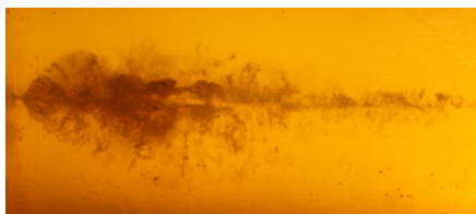
Meget hurtig fragmentering, med størstedelen af energien efter 3 cm.
