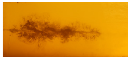
Med en kraftig aflevering af energi indenfor de første 25 cm viser TTSX'en sin høje kvalitet.
